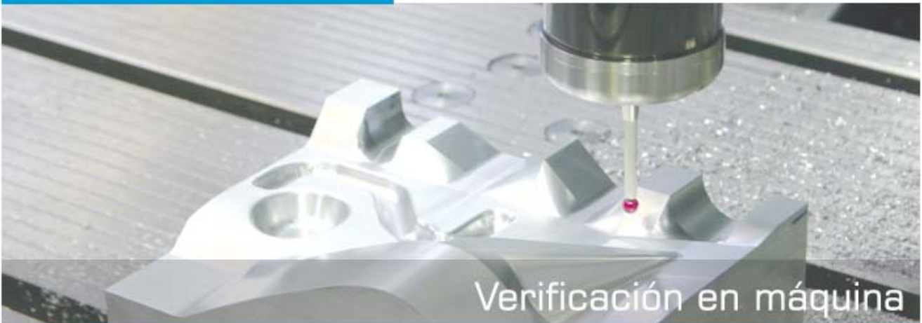
Inspección de partes 3D complejas basadas en el modelo CAD
